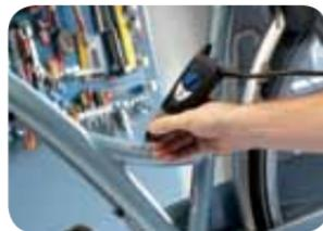
Pontas substituíveis de metal duro e diamantadas. Gravação em materiais macios ou duros.
